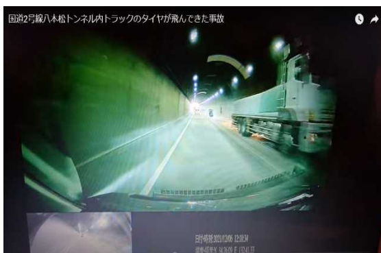
大型トラックの左後輪タイヤ2本が外れるとともに、車軸が路面に接地し火花が発生
